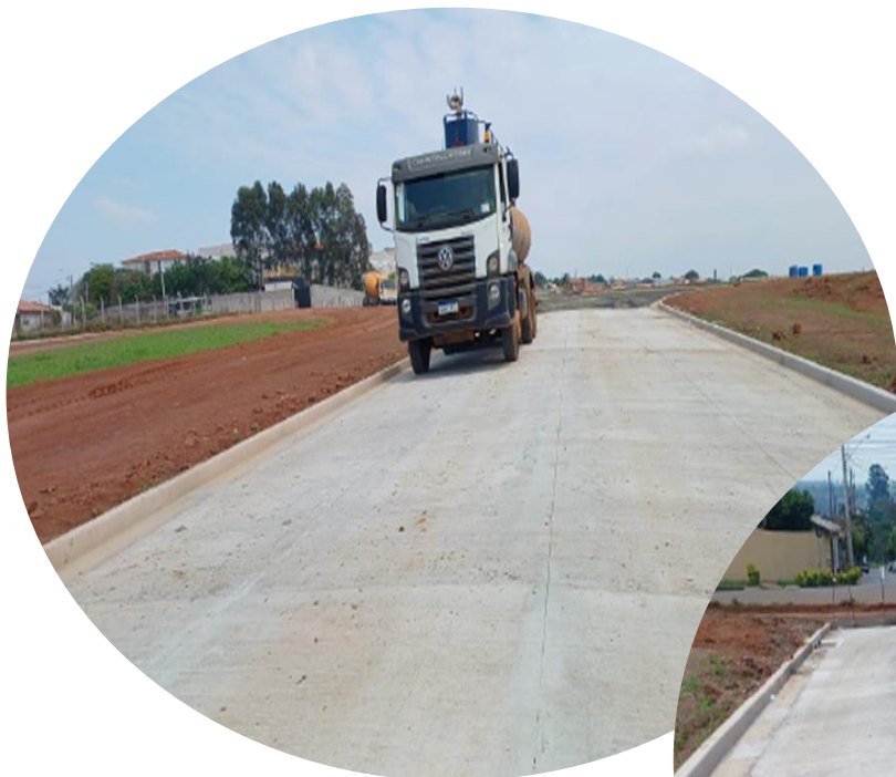
Execução de teste de carga em pavimento simulando as condições de uso geral
