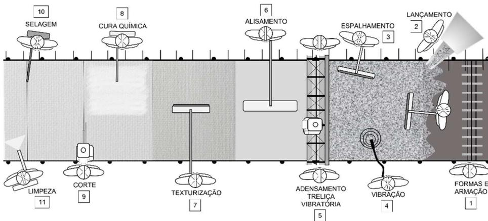
Além do equipamento principal de espalhamento (adensamento/alisamento) do concreto, a executora fará uso dos seguintes equipamentos complementares para a correta execução do pavimento:
