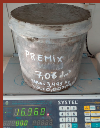
Foto 1: Muestreo y moldeo de PUV en hormigones masivos.
