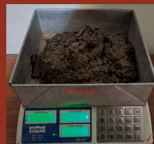
Foto 2: Ensayo de peso unitario (pesaje en balanza de precisión y recipiente calibrado).
