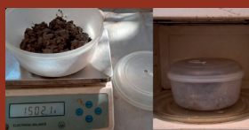
< Foto 6: Secado final en horno hasta masa constante.
