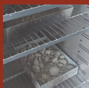
< Foto 5: Secado en hornalla para hormigones convencionales
