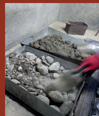
Foto 3: Pesaje de la muestra de hormigón fresco con la tara incluida.
