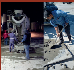
Foto 1: Muestreo y moldeo de PUV en hormigones masivos.
